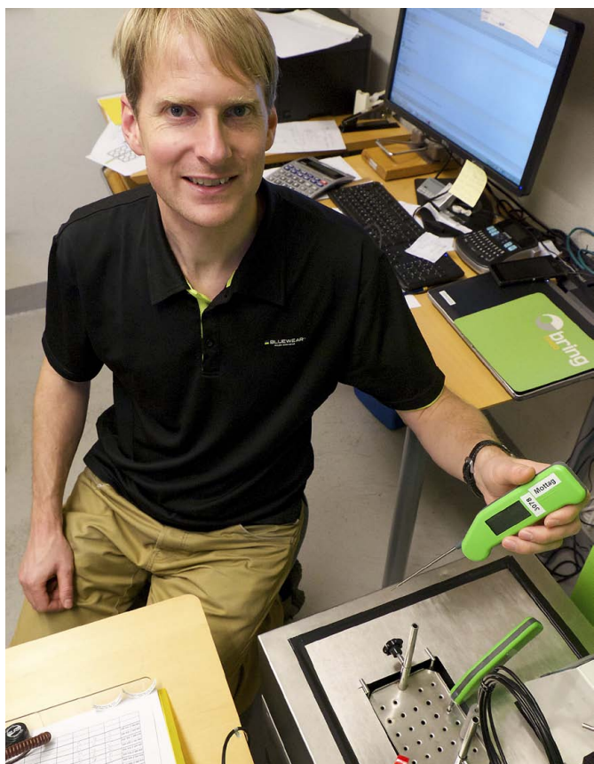
Torbjörn Svensson kalibrerar alla instrument och temperaturgivare inom Bring Frigo en gång om året, för att djupfrysta livsmedel ska hålla -18^{\circ}\text{C} i butiken.
