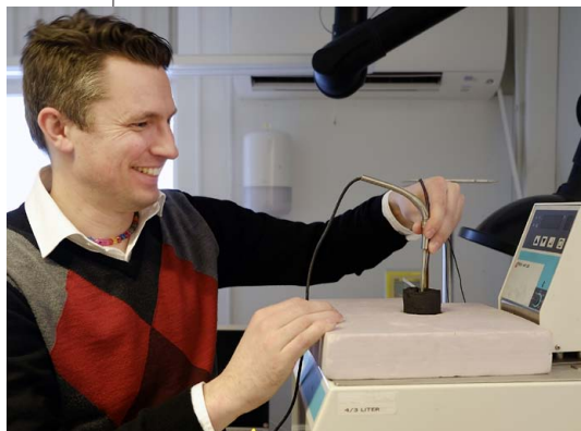
Spårbarheten i temperaturmätningarna upprätthåller David genom kalibrering i vattenbad mot externt kalibrerad referensgivare.
