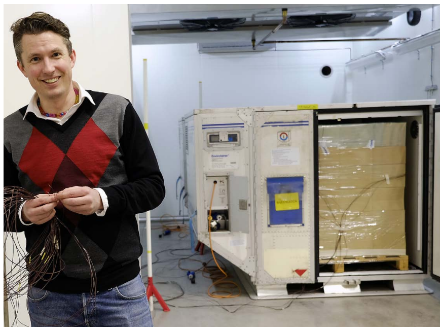
Envirotainer testar containrar och olika lastkonfigurationer i egna klimatkammare.
