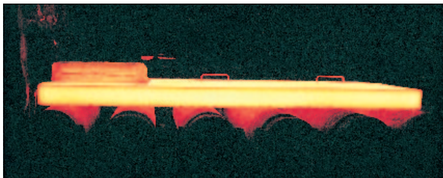
Den rödglödgrade lådan till vänster på stålämnet innehåller en åttakanalig logger. Loggern skyddas av en barriär som klarar 1 200°C i upp till sex timmar.
