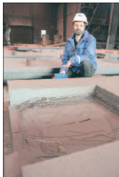
Jan Svensson visar stålämnet som används för att transportera Datapaq-loggern genom ugnen. Trådarna är åtta termoelement som mäter kontinuerligt under färden genom stegbalksugnen
