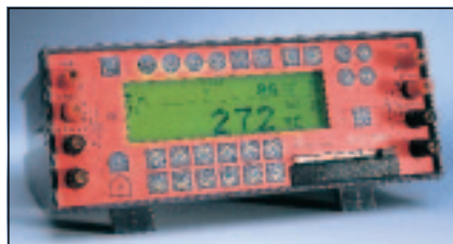
ISO-CAL 9000 är ett mångsidigt instrument för mätning och simulering som även dokumenterar mätresultaten.
