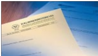
Kalibreringsbevis från ackrediterat laboratorium där hänsyn tas till samtliga inverkanfaktorer, vilket sällan är fallet i ISO 9000-certifikat.
