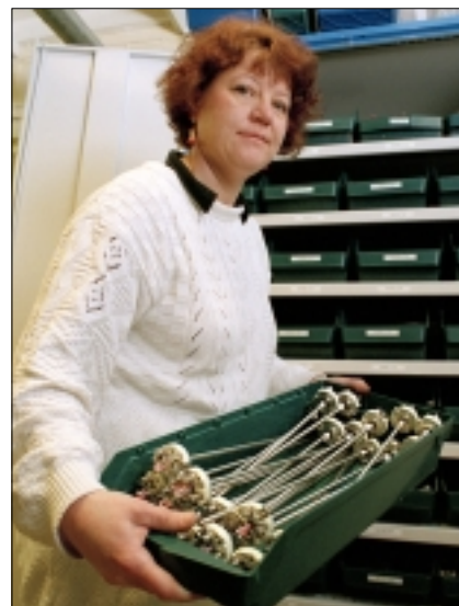
Susanne Johansson hämtar ut lagerförda temperaturgivare för slutkontroll. Det är måttinsatser för DIN form B som ska levereras till kund.
