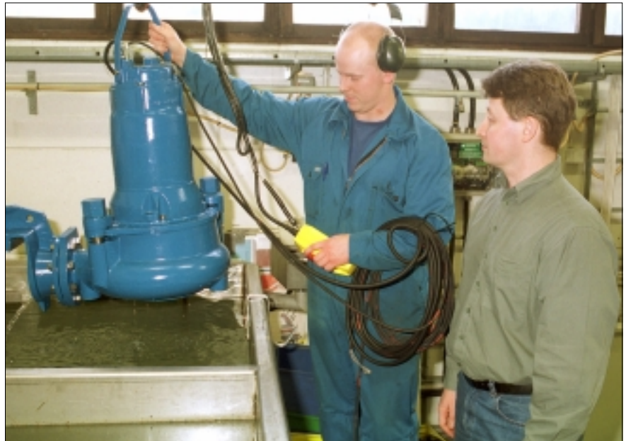
Varje avloppspump testas noga innan leverans. Här plockar Håkan Johansson upp en pump ur badet och Jan Olov Holmlund tittar på.
