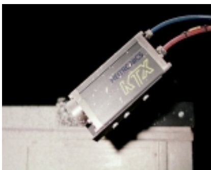
Temperaturen vid bestrykningen mäts med fyra Heitronics-pyrometrar.
