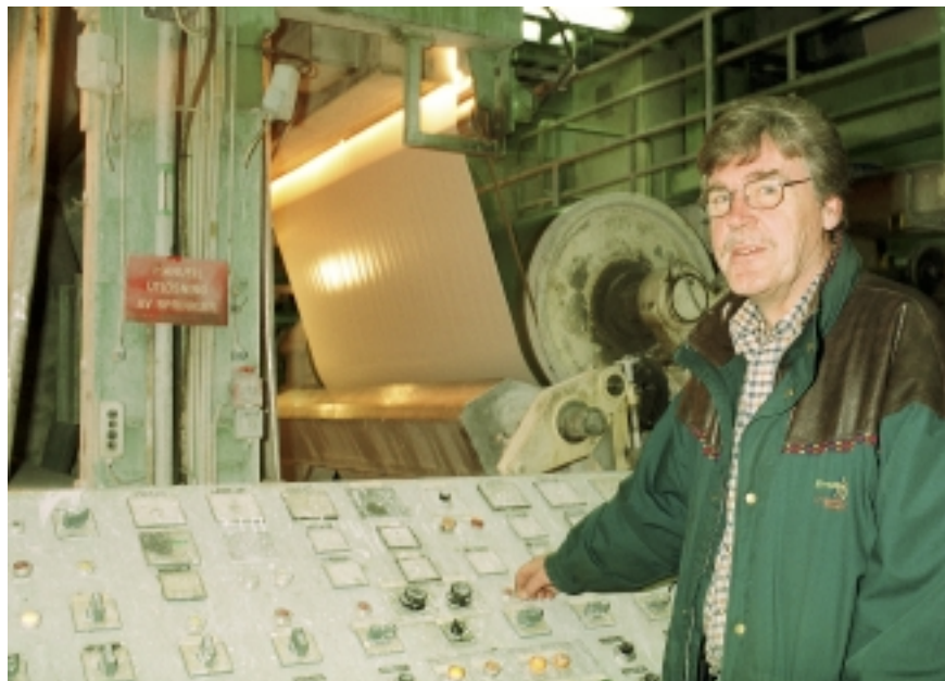
– Temperaturen under bestrykningen avgör hur papperet fungerar i en bläckstråleskrivare, säger Silverdalens tekniske chef Lars-Åke Peterson, här vid en av bestrykningsmaskinerna.
