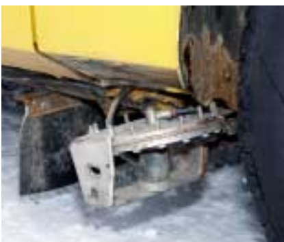
Den patenterade givaren Frensor mäter fryspunkten på vägen under körning.
