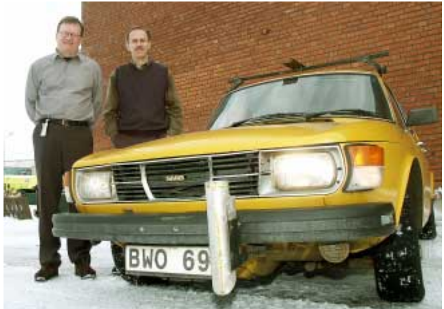
Med den här bilens hjälp och avancerad mätutrustning har Billy Backman, Per-Erik Persson och deras kollegor på AerotechTelub gjort våra vägar en smula säkrare. I röret på stötfångaren sitter en pyrometer.
