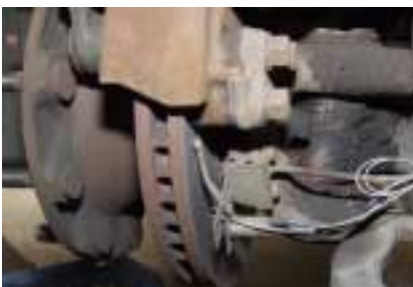
Installation av givare för temperaturmätning på skivbroms. Överst ett släpthermoelement, under syns en IR-pyrometer. Termoelementet fungerar bäst.
