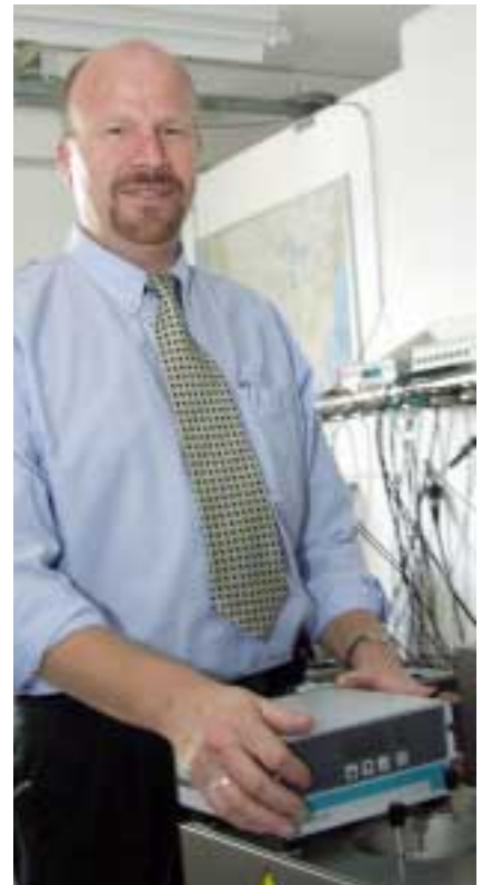
Jan Eriksen visar ett nytt kalibreringsbad under sluttest hos Heto. Ett äldre bad blir lika bra efter uppgradering med ny temperaturregulator och pump/värmeenhet.
