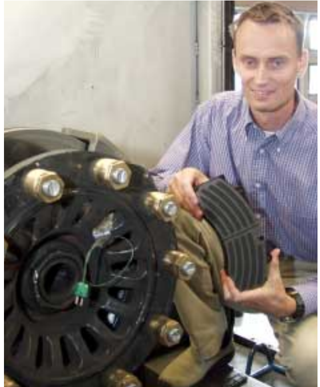
-Bromsklossen är en av de mest komplicerade produkter som finns. Den innehåller upp till 35 grundämnen, berättar Fredrik Rennstam som här syns vid en skivbroms monterad för test i dynamometer.
