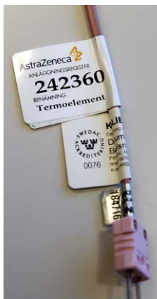
Även kontrollantens kontrollutrustning kontrolleras. Här är ett Termoelement av typ N som för in spårbarheten på Astra Zeneca från Pentronics kalibreringslaboratorium 0076.
