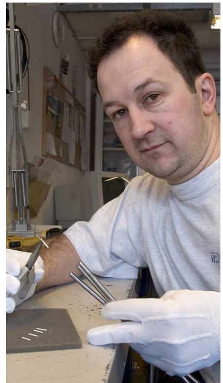
På utsidan av givaren syns inte vilken typ av Pt100-element som används. Men skillnaden i mätosäkerhet kan bli stor i högre temperaturer. Edin Beganovic är en av Pentronics skickliga hantverkare som bygger Pt100-givare.
