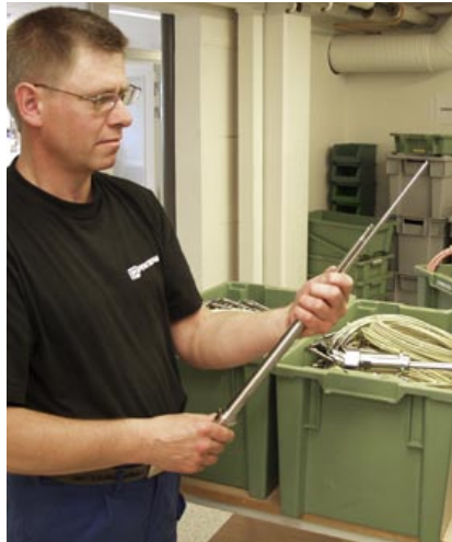
Egen svarvavdelning är nödvändigt för att tillverka kundspecifika givare, säger Leif Jansson, här med en uppsättning specialgivare som bär hans signatur, avsedda för gasturbiner.
