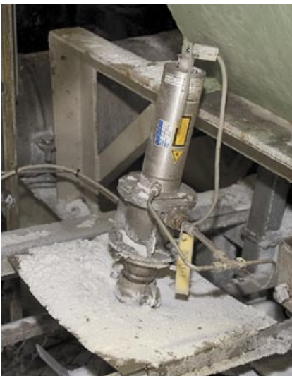
Heitronics pyrometer CT15 har ett avancerat innehåll, skyddat i ett rejält stål rör som tål tuffa förhållanden.
