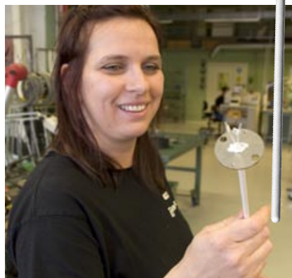
Figur 2. Termoelement av ädelmetalltyp måste kapslas i högren keramik vet Monica Gustafsson att berätta. Här visar hon en mätinsats som är avsedd för den intilliggande givaren med keramiskt yttre skydds rör.
