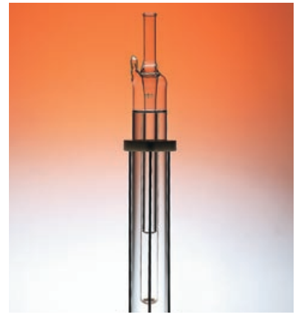
Trippelpunkten för vatten (0,01°C) är den fundamentala fixpunkten i temperaturskalan ITS-90 som definierar enheterna 1 °C och 1 K som är lika stora. Temperaturskalans nollpunkt (0 K alt -273,15 °C) går ej att realisera fullt ut. Världsrymdens bakgrundsstrålning är mycket låg och uppgår till ett par grader K.
