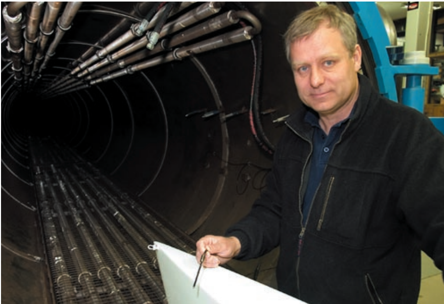
Per Wärn framför den 35 meter långa autoklaven. Jämn temperatur över hela sträckan garanteras av ånga och noggrann temperaturmätning med Pt 100-givare. Eftersom industriautoklavens atmosfär värms av ånga via värmeväxlare - ångrören är försedda med flänsar - behöver givarna med kablage inte vara ångbeständiga som t ex vid sterilisering.
