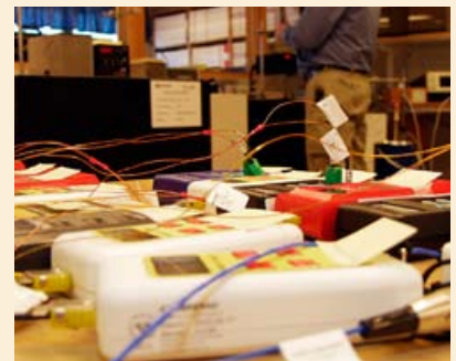
Miljökontorens väl skötta termometrar håller prestanda mycket bra efter mer än 10 års drift. Det framgår vid den ackrediterade kalibreringen, som här förbereds med det ursprungliga vita instrumentet i förgrunden.
