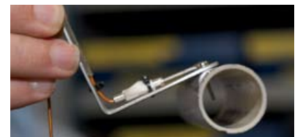
Volvos egen konstruktion av skyddande skärm för säker mätning av utetemperaturen när provbilen kör. Enheten hängs på utsidan av sidofönstret.
