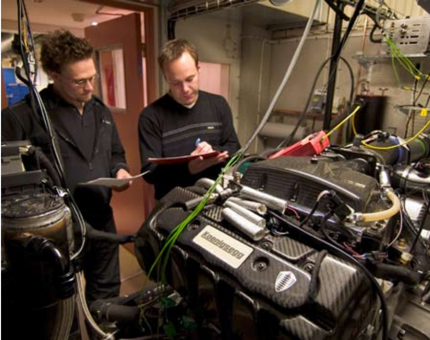
Marco Garver (t v) och Pentronics Lars Grönlund går igenom mätutrustningen inför certifieringsprovet av Koenigseggs nya etanolmotor. Effekten är 1018 hk.
