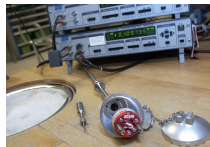
Samtrimning av givare och transmitter är en allt mer efterfrågad tjänst. T v Pentronics nya givare med integrerad transmitter, t h en konventionell givare med transmitter i kopplingshuvudet.
