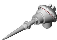
Figur 2a. Processgivare monterad i konisk dykficka med reducerad spets. Mätinsatsen är 3,0 mm och hålet i fickans spets 3,1 mm. Givaren används bl a för debiteringsmätare i fjärrvärmesystem.
