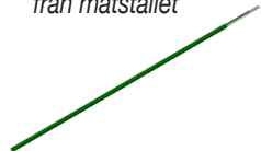
Figur 1. Trådtermoelementet har extremt liten massa med tunna ledare. Å andra sidan är den fysiska hållfastheten mycket begränsad i flöden.
