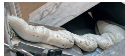
Extrudering av det som några produktionssteg senare blir pulverfärg.
