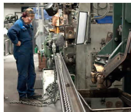
En av Gunnebos produktionslinjer för kätting.
