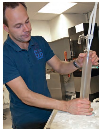
Laboratoriechefen Lars Grönlund aktiverar trippelpunkten för vatten. Pentronic erbjuder spårbarhet till temperaturskalan ITS-90 på flera olika sätt.
