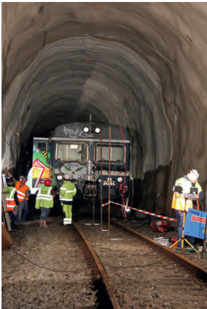
Här kartlägger forskarna vilka skador temperaturen gör på tunnlar om ett tåg börjar brinna. Foto: Per Rohlén
