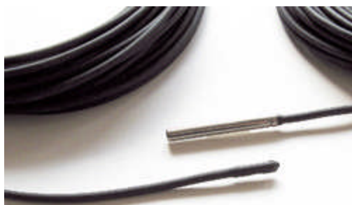
Vattentäta Pt100 i två utföranden, underst helvulkad kabel och mätkropp, överst rostfri hylsa vattentätt ansluten till vulkad kabel.
