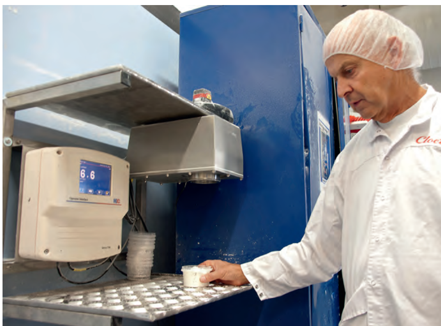
Fukthalten är avgörande för kvaliteten på skumprodukter, förklarar Kjell Lundqvist på Cloetta. Den kontrolleras med en beröringsfri NIR-mätare från NDC.
